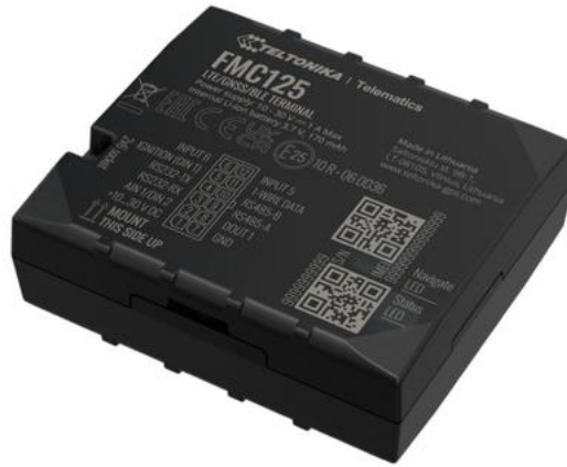
Рис. К.3.1 – Термінал Teltonika FMC125
